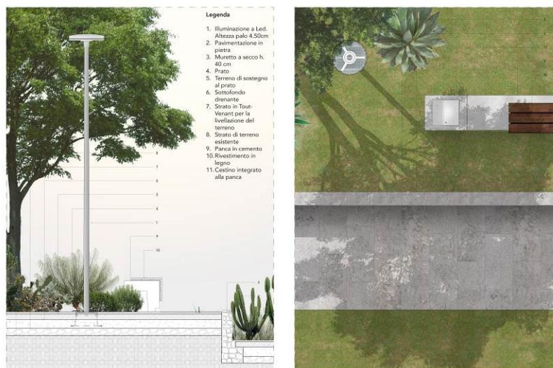
**Figura 4 - Dettaglio in pianta e sezione del sistema panca-lampione**
